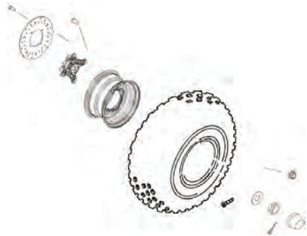
**WARNUNG!** Ein falsch montiertes Rad kann die Reifenabnutzung und das Fahrverhalten negativ beeinflussen und kann schwere oder tödliche Verletzungen verursachen. Die Muttern immer mit dem vorgegebenen Drehmoment anziehen. Die mit Splint versehenen Achsmuttern nicht warten. Ihr POLARIS-Händler kann Ihnen behilflich sein.
