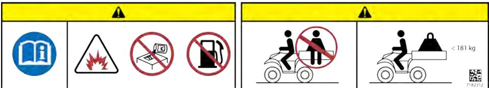
Behälter aus brennbarem Material vor dem Befüllen von der Pritsche nehmen. Beifahrer können vom Fahrzeug geschleudert werden. Dies kann zu schweren oder tödlichen Verletzungen führen. Niemals Personen auf der Pritsche mitfahren lassen.
