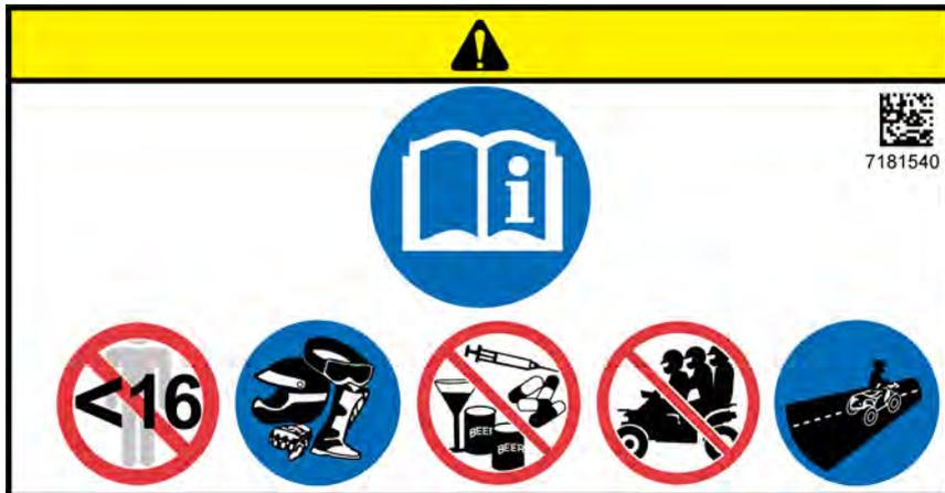
Vor Inbetriebnahme dieses Fahrzeugs Betriebsanleitung lesen. Personen unter 16 Jahren niemals erlauben, mit diesem Fahrzeug zu fahren. Zugelassenen Helm, Schutzbrille und Schutzkleidung tragen. Vor und während der Bedienung ist der Konsum von Alkohol und Drogen untersagt. NIEMALS mehr als einen Beifahrer mitführen. Dieses Fahrzeug ist für den Straßenbetrieb zugelassen.
