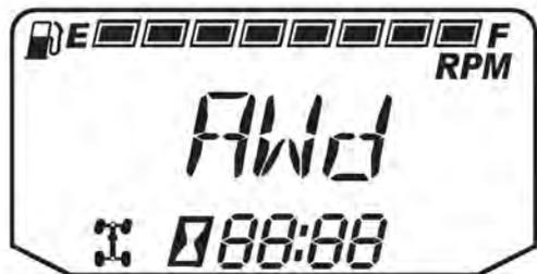
Nach der Zuschaltung bleibt der Allradantrieb (AWD) aktiv, bis der Schalter ausgeschaltet wird. Schaltet man den Schalter aus, während das bedarfsgesteuerte Antriebssystem in Bewegung ist, kuppelt sich dieses erst aus, wenn die Hinterräder wieder Bodenhaftung haben.
