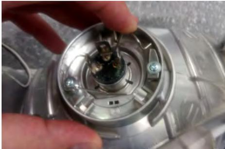
5. Neue Glühlampe in das Gehäuse einsetzen.
