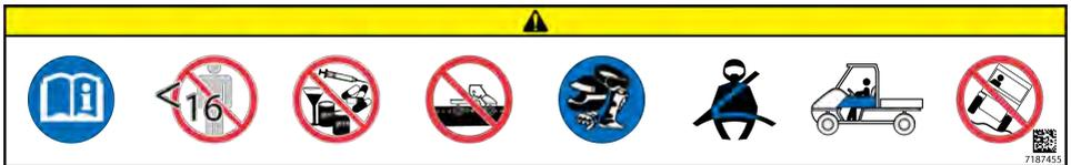
Die Betriebsanleitung lesen. Personen unter 16 Jahren niemals erlauben, mit diesem Fahrzeug zu fahren. Vor und während des Fahrens bzw. Mitfahrens ist der Konsum von Alkohol und Drogen untersagt. Dieses Fahrzeug ist nicht für den Straßenbetrieb zugelassen. Zugelassenen Helm, Schutzbrille und Schutzkleidung tragen. Die Sicherheitsgurte jederzeit anlegen. Die Kabinennetze bzw. Türen müssen stets verwendet/geschlossen werden. Die Sitzplatzkapazität niemals überschreiten.
