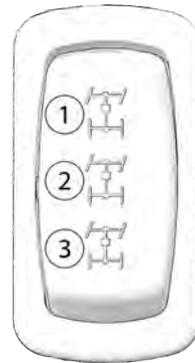
Der Allradantrieb muss zugeschaltet werden, bevor das Fahrzeug in einen Bereich gerät, in dem es auf den Vorderradantrieb angewiesen sein könnte. Wenn die Hinterräder durchdrehen, Gaspedal vor dem Zuschalten des Allradantriebs freigeben.
