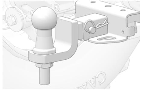
1. Um die Anhängervorrichtung (sofern vorhanden) abzunehmen, den Federstecker ① und den Kupplungsbolzen ② entfernen. Die Anhängervorrichtung abnehmen, dann den Kupplungsbolzen ② wieder anbringen und den Federstecker ① sichern.
