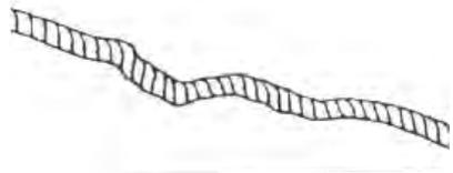
Windenseile aus Synthetikfasern müssen auf Ausfransen hin kontrolliert werden. Bei Anzeichen von Ausfransen ist das Seil auszuwechseln (siehe rechts). Ein Windenseil in diesem Zustand darf nicht mehr benutzt werden. Das Windenseil ist ferner auszuwechseln, wenn Fasern zusammengeschweißt oder angeschmort sind. An solchen Stellen ist das Synthetikfaserseil steif und sieht glatt oder blank aus. Ein Windenseil in diesem Zustand darf nicht mehr benutzt werden.
