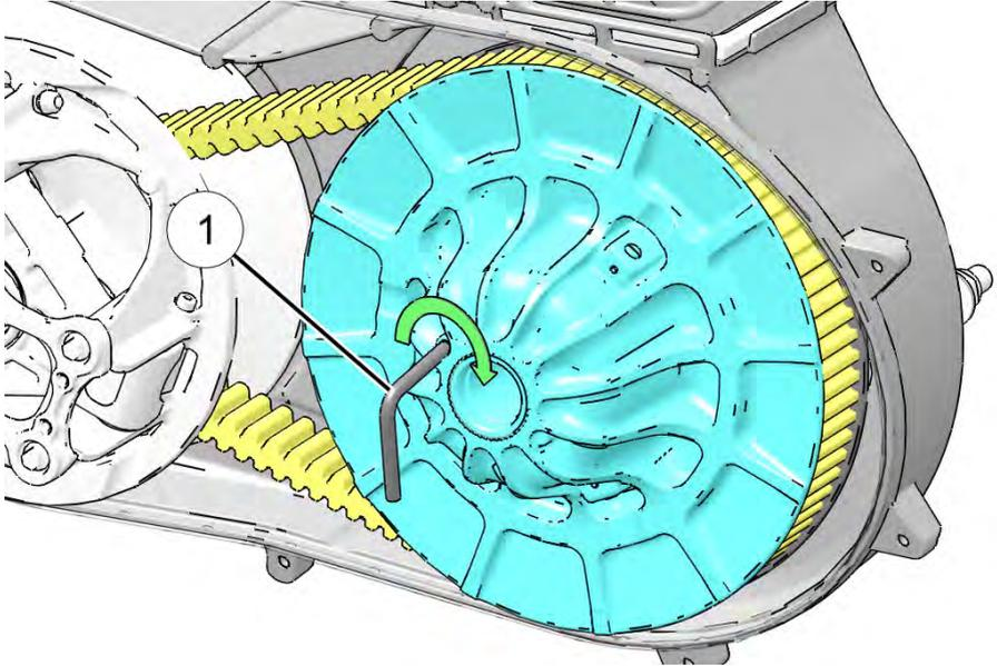
2. Die Abtriebskupplung drehen und den Riemen in die Kupplung einlegen.
