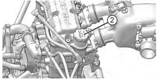
Der Ölmesstab befindet sich am Motor. Der Ölmesstab ist durch den rechten Hinterradkasten zugänglich.
