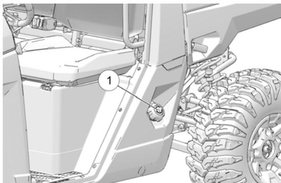
Immer sicherstellen, dass der Tankdeckel fest und sicher aufgeschraubt ist, bevor das Fahrzeug betrieben oder transportiert wird.
