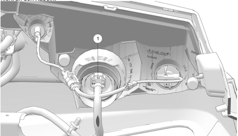
4. Die Glühlampe gegen den Uhrzeigersinn drehen und aus dem Scheinwerfergehäuse herausnehmen.
