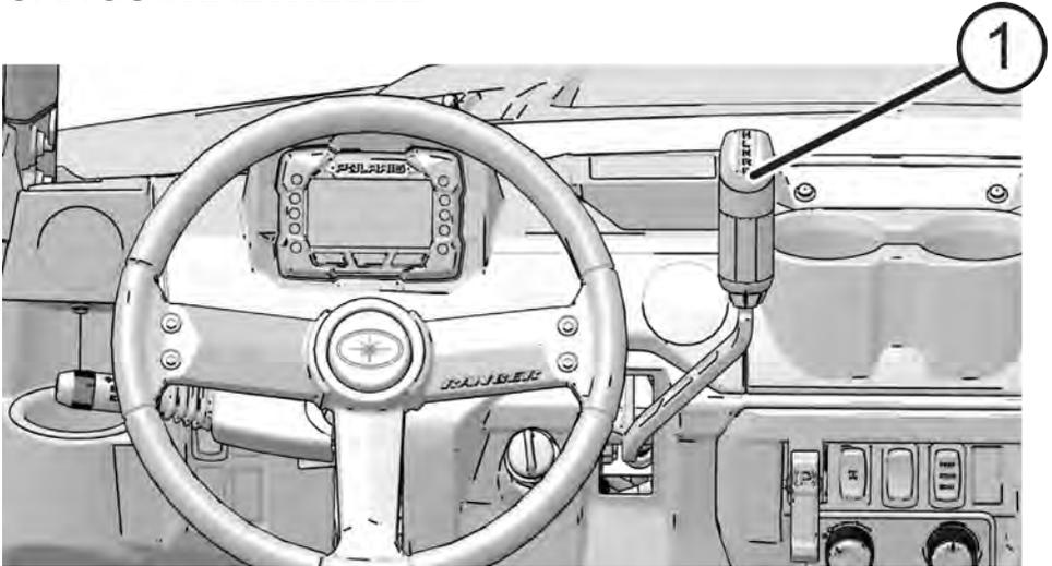
Zum Gangwechsel das Fahrzeug anhalten und bei leerlaufendem Motor mit dem Hebel ① in den gewünschten Gang schalten. Bei Motordrehzahlen oberhalb der Leerlaufdrehzahl oder während der Fahrt nicht den Gang wechseln.
