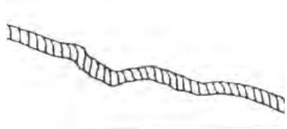
Windenseile aus Synthetikfasern müssen auf Ausfransen hin kontrolliert werden. Bei Anzeichen von Ausfransen ist das Seil auszuwechseln (siehe rechts). Ein Windenseil in diesem Zustand darf nicht mehr benutzt werden. Das Windenseil ist ferner auszuwechseln, wenn Fasern zusammengeschweißst oder angeschmort sind. An solchen Stellen ist das Synthetikfaserseil steif und sieht glatt oder blank aus. Ein Windenseil in diesem Zustand darf nicht mehr benutzt werden.
