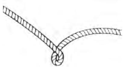
Auf der Abbildung rechts ist ein eingeknicktes Windendrahtseil zu sehen, das gerade gebogen wurde. Es mag zwar brauchbar aussehen, ist jedoch irreparabel und schwer beschädigt. Es ist nicht mehr in der Lage, die Last zu übertragen, der es im intakten Zustand standhalten konnte. Ein Windenseil in diesem Zustand darf nicht mehr benutzt werden.
