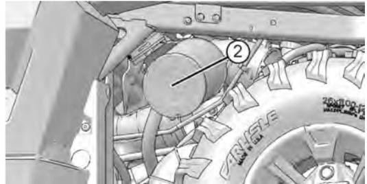
1. Die Pritsche anheben, um Zugang zum Luftfiltergehäuse zu erhalten.
